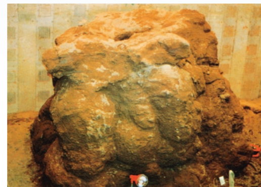
注入ゾーン固結状況
