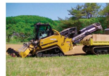
型・軽量の専用機「PUMA2400」を用いて、農地表層を効率的に削り取ります。
