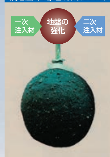
浸透注入の原理（球体状をしめす）
