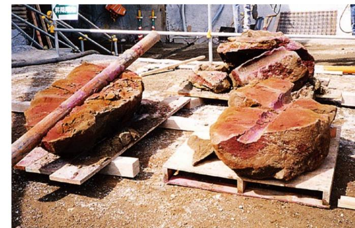
AGF-RL工法による実証実験 (砂質土)
