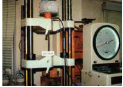
鉄筋付着強度試験
