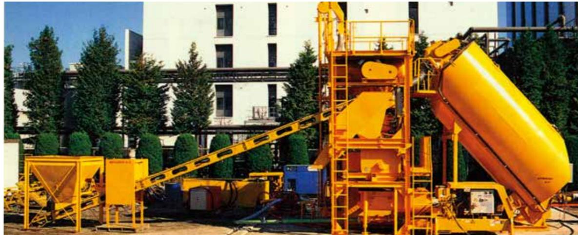
長距離と高揚程圧送を可能にするため、高い吐出圧力が必要となりますが、現場に適用可能な規模を考慮して、ユニラップ工法は小口径吐出口のユニラップポンプで圧送することを特長とします。また、自動プラントを用いることによって、各種材料の計量・混練り作業における品質管理が確実になります。
