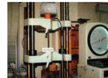
鉄筋付着強度試験
