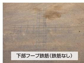
下部フープ鉄筋(鉄筋なし)
