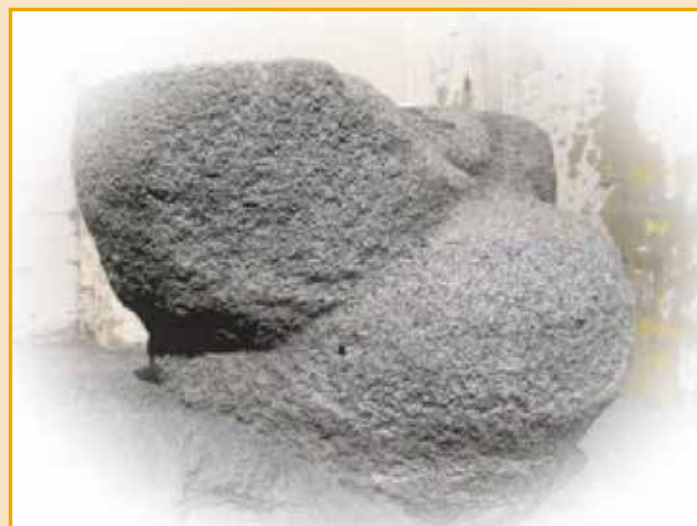
NEOソレタンシュ工法による改良体(砂礫地盤)
