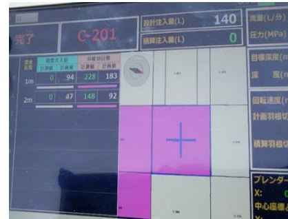
写真6 タブレットによる施工済箇所の確認 (SCM 工法)
